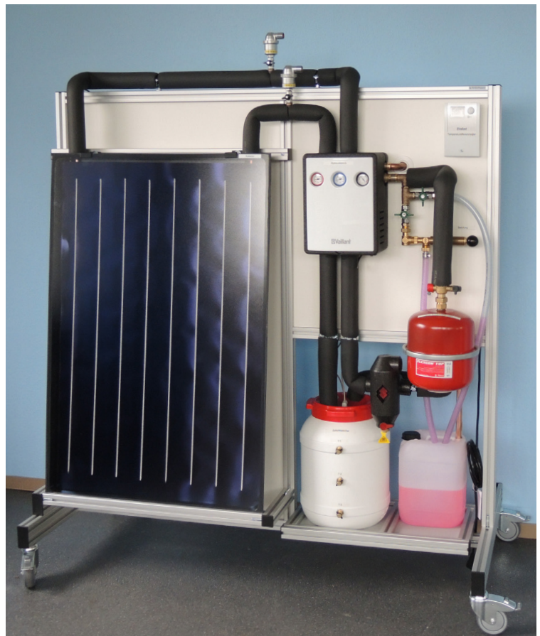
Schulungsstand Solaranlage, Flachkollektor
