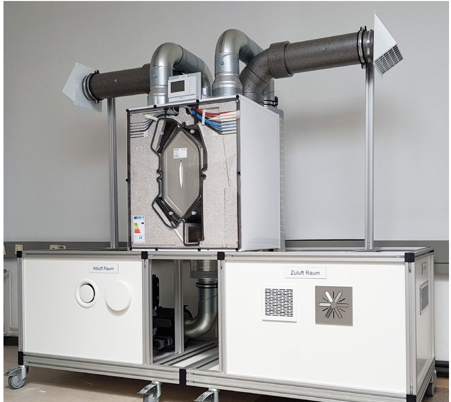
Schulungsstand Kontrollierte Wohnraumlüftung, Fabrikat Viessmann
