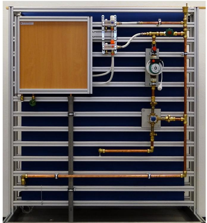
Modulsatz 2. Heizkreis aufgebaut auf dem Versuchs- und Montagewagen 571730
